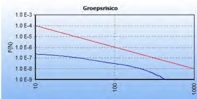
5.7 Figuur 5.7 FN curve voor 6495_leiding-Z-500-15-deel-1_excl verl van N.V. Nederlandse Gasunie voor de kilometer tussen stationing 0.00 en stationing 1000.00
