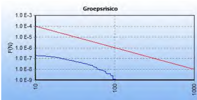
5.13 Figuur 5.13 FN curve voor 6498_leiding-Z-500-15-deel-1_incl verl van N.V. Nederlandse Gasunie voor de kilometer tussen stationing 0.00 en stationing 1000.00
